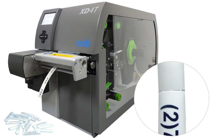
XD4T 可双面打印布质标签、热缩套管或已预制的连续性合成纸张及吊牌纸卡。马达驱动滚轴可将碳带和标签分离并提高打印精度。
